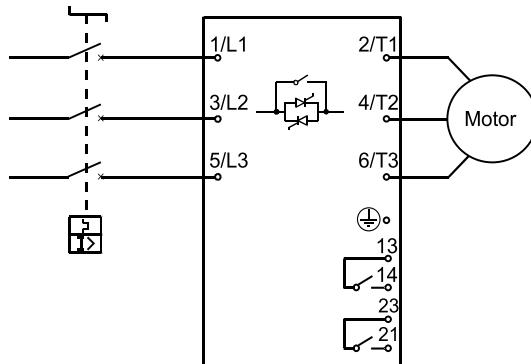
Пример 2: Подключение УПП с автоматическим выключателем и линейным контактором.
