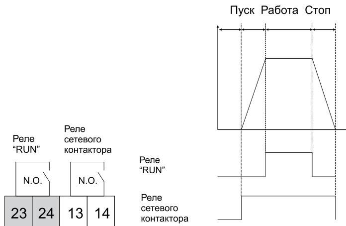
Нагрузка реле: 6 A, 30VDC – резистивная нагрузка, или 2 A, 400 VAC – нагрузка AC11
