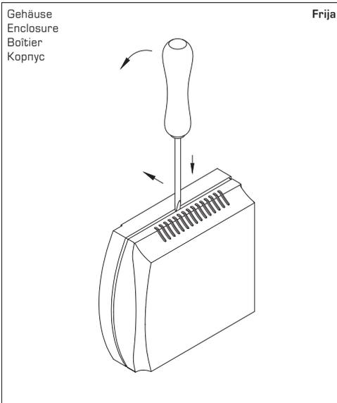
Zum Öffnen des Gehäuses einen Schraubendreher (2,0) in die Nut mittig ansetzen, nach unten drücken und den Bodenrahmen etwas anheben. Den Deckel nach vorne ziehen und halten.
