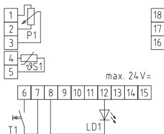
Schéma de raccordement **RTFxxPW**
