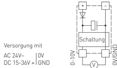
Werden mehrere Geräte von einer 24V **AC-Spannung** versorgt, ist darauf zu achten, dass alle „positiven“ Betriebsspannungseingänge (+) der Feldgeräte miteinander verbunden sind, sowie alle „negativen“ Betriebsspannungseingänge (-) = Bezugspotential miteinander verbunden sind [phasengleicher Anschluss der Feldgeräte]. Alle Feldgeräteausgänge müssen auf das gleiche Potential bezogen werden!
