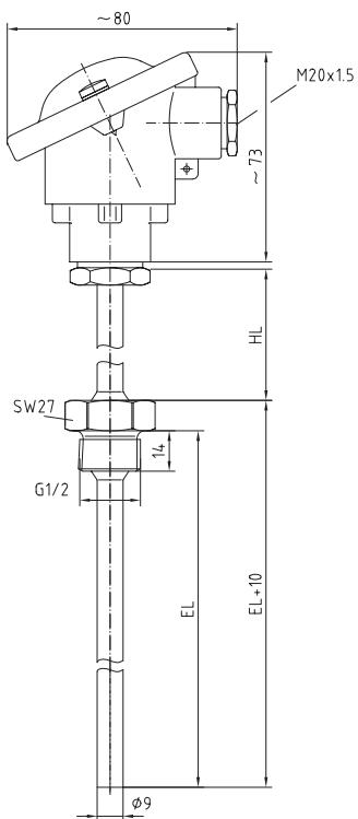
Einschraubwiderstandsthermometer/Rauchgastemperaturfühler mit Halsrohr THERM-ASGARD® RGT2 mit passivem Ausgang, auswechselbarem Messeinsatz und geradem Schutzrohr zur Erfassung von relativ hohen Temperaturen in gasförmigen oder flüssigen Medien, z.B. zur Abbluft-/Rauchgastemperaturmessung.
