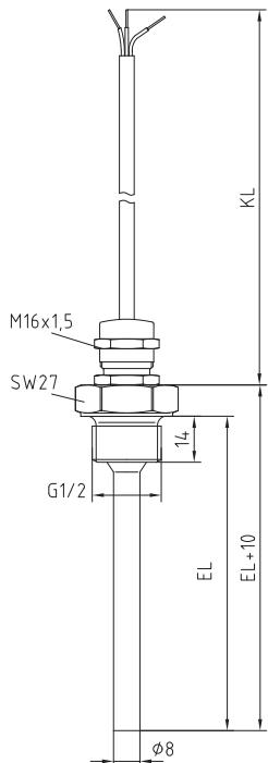
Einschraubwiderstandsthermometer/Tauchtemperaturfühler THERMASGARD® ESTF mit passivem Ausgang und Kabelanschluss, zum Einbau in Rohrleitungen, Behältern, Kesseln. Die Temperaturnummernstelle ist komplett im Einschraubfühler integriert und kann so leicht in Rohrleitungen eingebaut werden. Der Kabelfühler ist austauschbar. Er dient zur Temperatur erfassung in flüssigen oder gasförmigen Medien, in Anlagen der Heizungs-, Lüftungs- und Klimatechnik.
